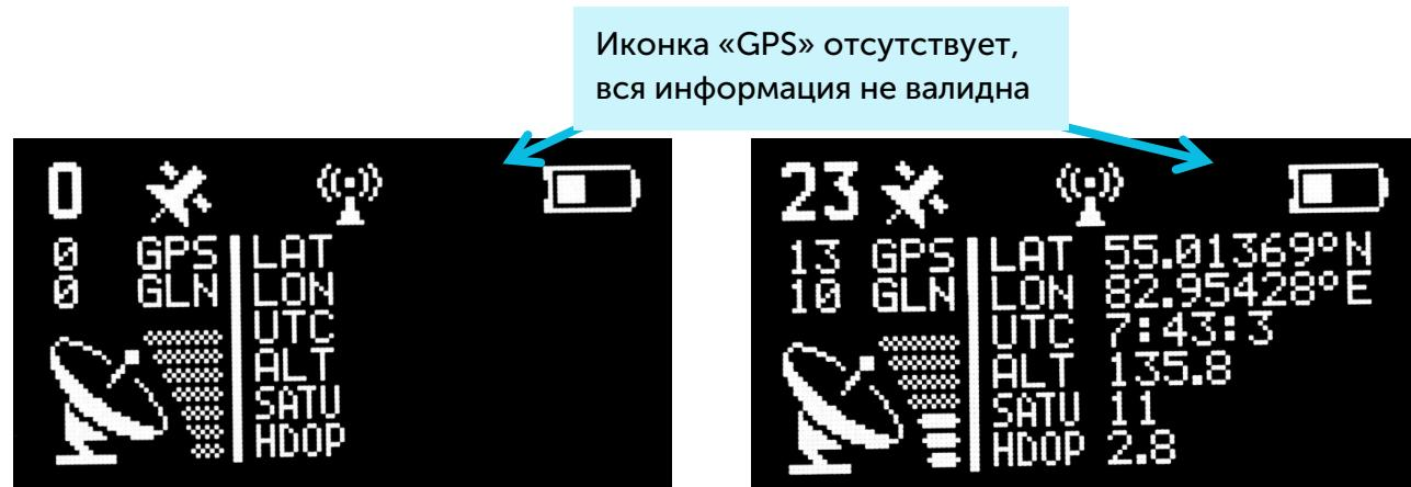
Когда функция определения координат включена, возможны два состояния иконки «GPS»:
