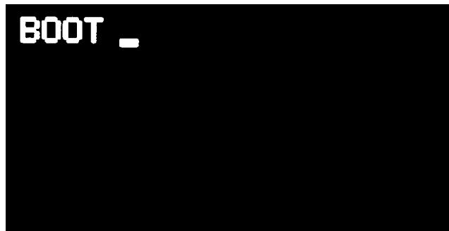
5. Пока активен загрузчик (пока отображается надпись «BOOT» на дисплее тестера) необходимо нажать кнопку «Подключиться» в программе «Vega LoRaWAN configurator». Начнется загрузка файла прошивки. Процесс загрузки отображается и в конфигураторе, и на дисплее тестера сети. По окончании процесса загрузки тестер сети сразу запустится под управлением обновленной программы.
