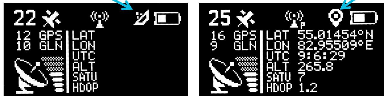
**Левая часть экрана** отображает количество видимых спутников, а также качество сигнала, эта информация валидна всегда при включенной функции определения координат.
