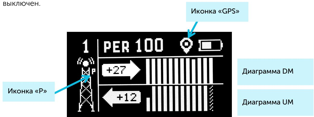
**Диаграммы DM и UM** - стрелка указывает направление распространения радиосигнала, а диаграмма отображает историю его изменения. Уровень каждого столбика диаграммы отображает запас демодуляции конкретного пакета. Самый последний (недавний) радиообмен отображается на столбике, расположенном рядом со стрелкой. На самой стрелке выводится численное значение запаса демодуляции в дБм самого последнего радиообмена. В процессе выполнения новых передач диаграмма сдвигается вправо.
