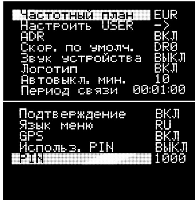
Частотный план – выбор стандарта сетки частот. EUR – европейский частотный план. RUS – российский частотный план, USER – произвольный частотный план.
