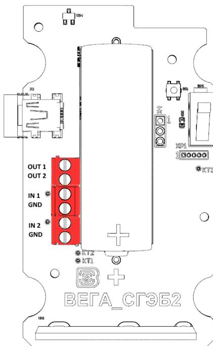
Счетчик импульсов Вега GM-2 имеет дополнительную возможность подключения двух охранных входов **IN1** и **IN2**, расположенных на плате устройства. Счетчик импульсов следит за их замыканием или размыканием, в зависимости от заданных настроек в программе «Vega LoRaWAN Configurator». В случае срабатывания охранного входа устройство активируется и отправляет в сеть сообщение с сигналом тревоги.
