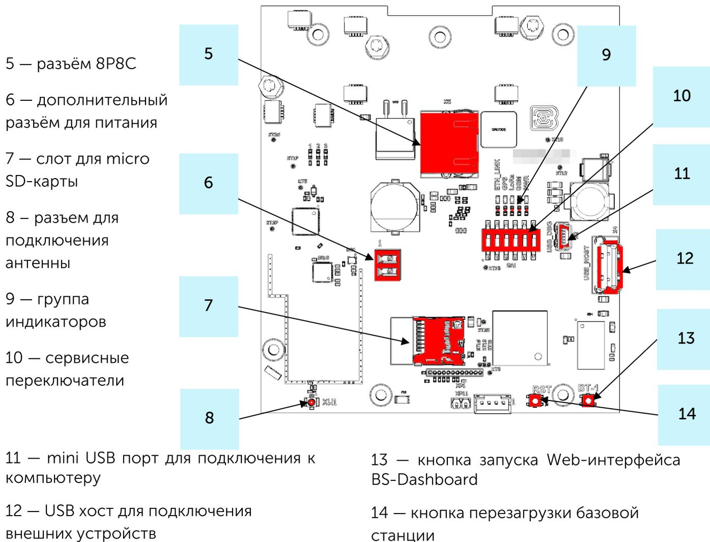
Базовая станция подключается к сети интернет 8-жильным сетевым кабелем (витая пара), через разъем 8P8C на плате. Кабель может быть обжат по стандартам T568A и T568B. Контакты нумеруются с 1-го по 8-й справа налево.
