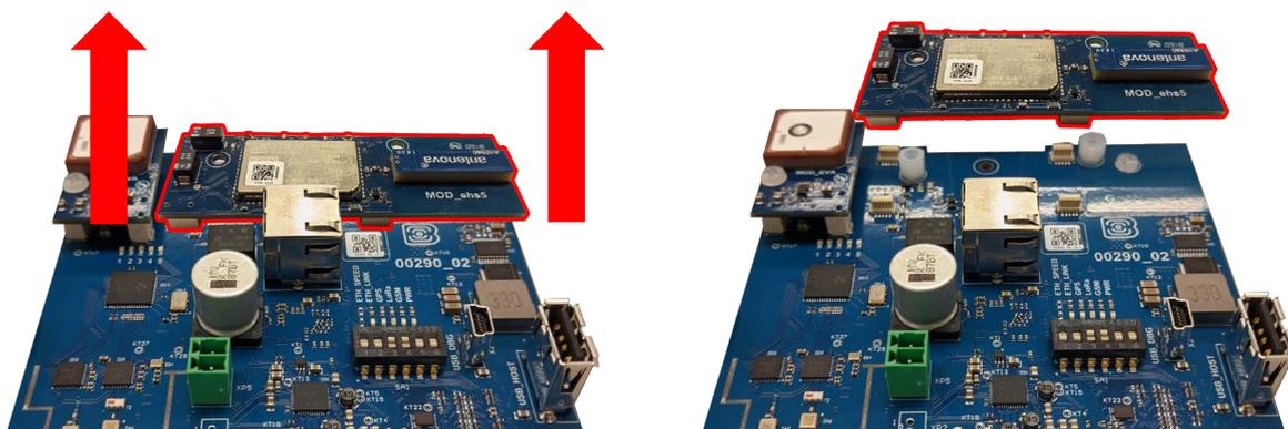
Гнездо для SIM-карты расположено с обратной стороны модуля. Чтобы установить SIM-карту, необходимо отсоединить модуль GSM от основной платы и перевернуть его.
