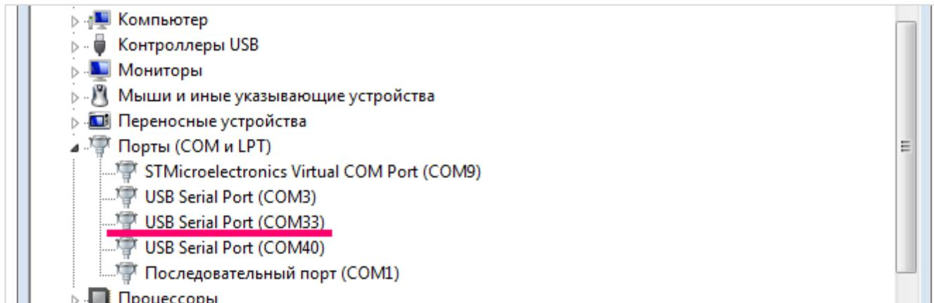
После этого открыть программу PuTTY, выбрать способ подключения **Serial**, и ввести номер виртуального COM-порта базовой станции и скорость (115200) в соответствующие поля.
